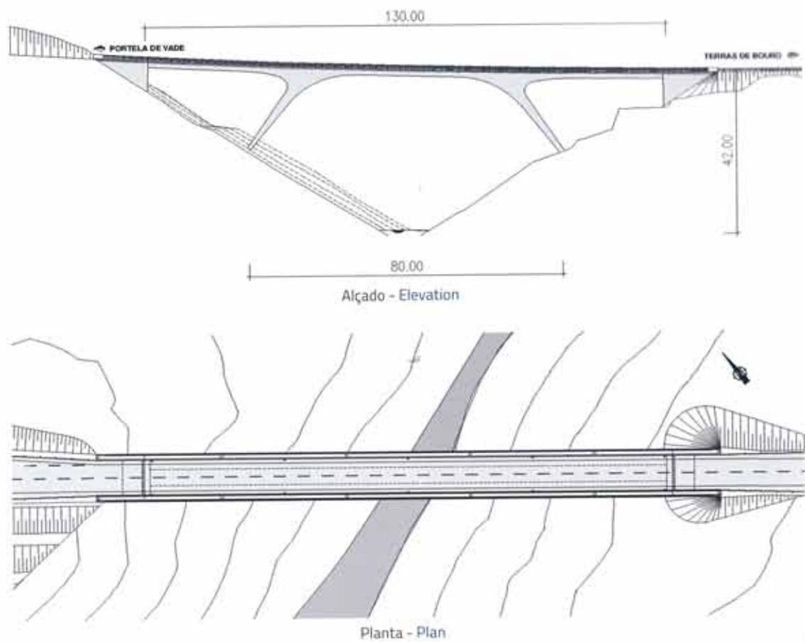
A ponte foi executada em duas fases, correspondendo a primeira fase à execução de encontros, pilares e tramos laterais do tabuleiro e a segunda fase ao fecho do tramo vão central do tabuleiro.
